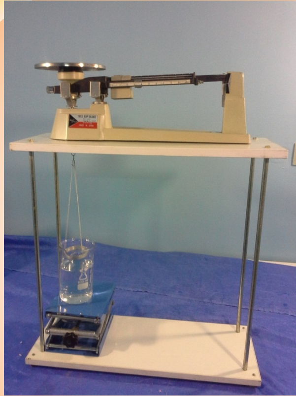
آزمایش کشش سطحی مایعات
